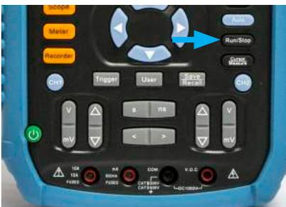
En prenant des mesures, **RUN/STOP** gèle l'écran. Quand il est arrêté, le mot STOP s'affiche dans le coin supérieur de l'écran.
