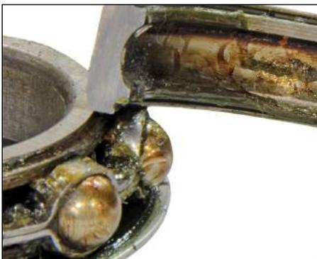
3. **Inspecter la graisse** et la contamination du roulement.
