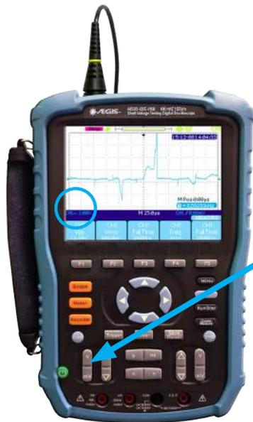
Le profil d'une décharge par électroérosion montre une augmentation de la tension suivie d'un segment vertical. Le segment vertical indique le moment de la décharge à la terre. Pour obtenir une bonne image d'une décharge, vous pouvez avoir besoin d'ajuster l'échelle d'affichage.
