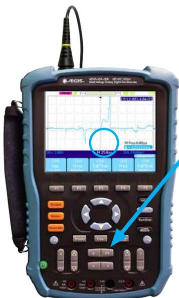
Vérifier l'échelle horizontale du signal affiché en ajustant l'échelle de temps. 500  $\mu$ s (microsecondes) est un bon point de départ, puis ajuster la durée selon les conditions. Le paramètre sélectionné en secondes par division est affiché en bas au centre de l'écran. Il est préférable d'afficher les formes d'onde EDM avec un paramètre de 50  $\mu$ s/div ou moins. Ajuster le paramètre de temps pour afficher la forme d'onde souhaitée.
