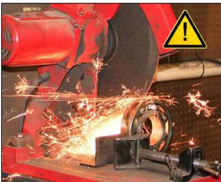
2. **Découper la bague extérieure** en deux. Retirer les joints et les protections avant de découper.
