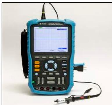
L'oscilloscope est maintenant configuré pour étalonner la sonde. L'AEGIS-OSC-9100 comprend une clé d'étalonnage à deux broches qui se branche sur le côté de l'oscilloscope. La clé micro-USB génère une onde carrée utilisée pour affiner la sonde.
