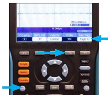
Appuyer sur **CH1** pour amener le menu CH1 en Page 1/3. (Si une page différente s'ouvre, appuyer sur **F5** pour revenir à la Page 1/3). Appuyer sur **F4 Probe**
