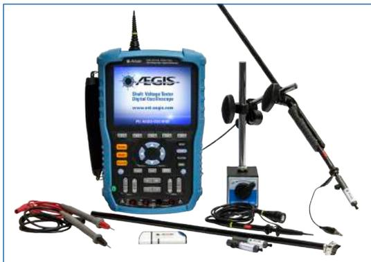
Le kit AEGIS® Shaft Voltage Tester™ inclut tout ce dont vous avez besoin pour commencer à tester les tensions d'arbre. En son centre se trouve un oscilloscope numérique 2 voies, 100 MHz avec un écran 5,7" et une capture d'écran simple.
