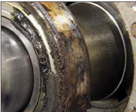
1. **Inspecter l'extérieur et l'intérieur des roulements** et conserver un échantillon de lubrifiant pour d'éventuelles futures analyses. Chercher à identifier :
