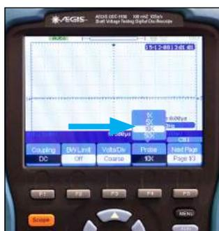
Sélectionner **10X** avec les flèches haut et bas bleues et appuyer sur **▶**. Appuyer sur **MENU** pour quitter le menu **CH1**.
