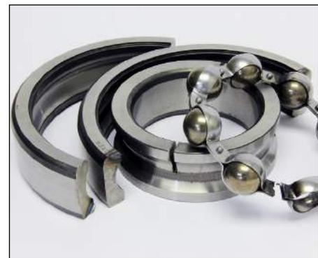
6. **Corrosion** : Cela se manifeste par une ligne grise décolorée sur tout le tour du chemin du roulement. Ce phénomène peut être vu aussi bien sur la bague intérieure que la bague extérieure. La décoloration peut être due à l'usure ou l'électroérosion. Une observation avec un microscope peut être nécessaire pour déterminer la nature de cette décoloration. Si le moteur était commandé par variateur sans protection de roulement, le dépolissage est très probablement causé par l'électroérosion.
