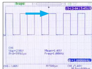
Appuyer sur **AUTO**. L'oscilloscope affichera un train d'ondes quasi-carrées d'amplitude 3 V et de fréquence 1 kHz.
