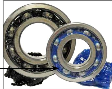
4. **Nettoyer les éléments du roulement** avec un solvant ou dégraissant.
